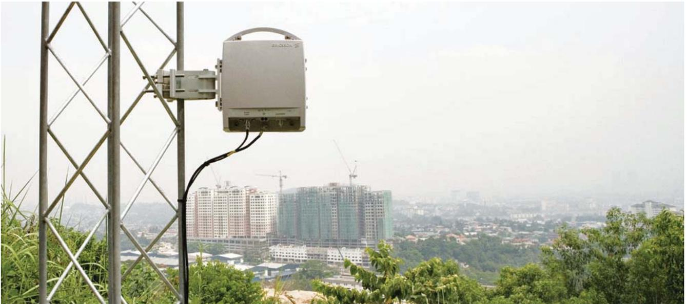
**Система MINI-LINK TN позволяет организовать полноценный радиорелейный канал, при этом имеется возможность управления PDH-, SDH-, Ethernet- и ATM-трафиком с одного узла, в пределах одного транзитного участка с использованием всех необходимых частот в диапазоне от 6 до 38 ГГц. Благодаря масштабируемым пограничным, ретрансляционным и концентрирующим узлам можно подобрать оптимизированное решение для любой площадки – от одного до восемнадцати модемов.**
